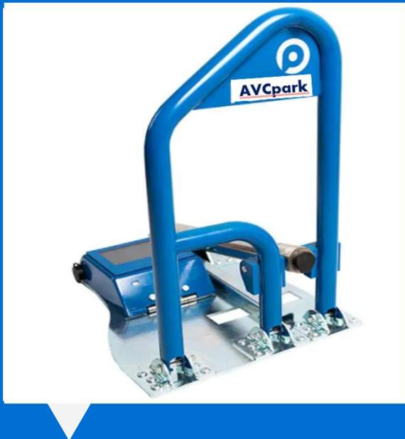
Dizajn osigurava zaštitu barijere od vandalizma i oštećenja ili neovlaštenih radnji. U slučaju prekomerne sile, sistem gumenih opruga unutar mehanizma apsorbuje uticaj automobila, samo će se osigurač slomiti a on se brzo može zameniti.
